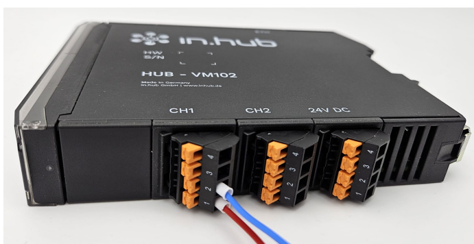
Anschluss eines Vibrationssensors von "PCB Piezotronic" am HUB-VM102 (hier im Beispiel mit Aderendhülsen)
