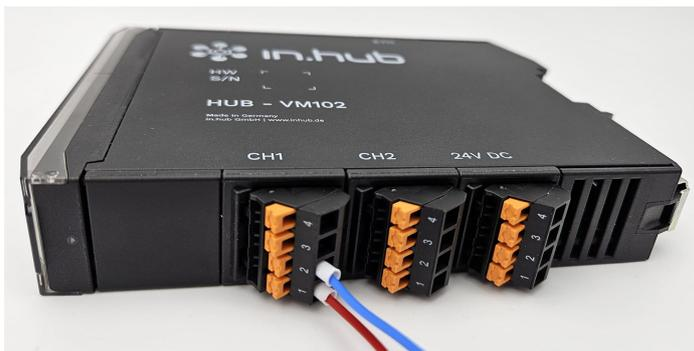
Anschlussleitung eines Vibrationssensors von "PCB Piezotronic" am HUB-VM102
