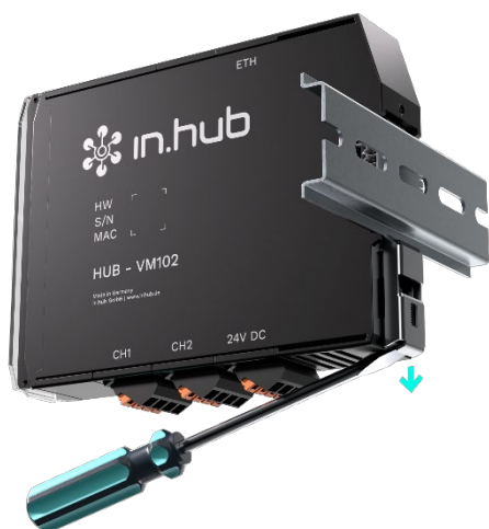
Abb. 5: Demontage des HUB-VM102 von der Tragschiene
