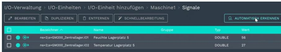
10. Nun wiederholen Sie die automatische Erkennung für den zusätzlichen Sensor, der über Modbus RTU an das HUB-GM200 im Zentrallager eingebunden ist.
