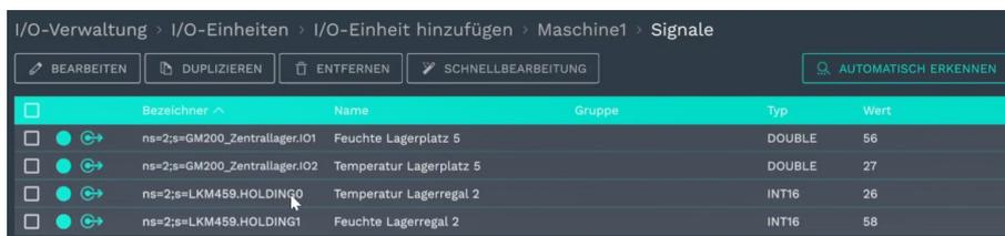
15. Wenn die Werte am Gateway an Maschine 1 nicht exakt den Messwerten vom Gateway im Zentrallager entsprechen, kann das z.B. daran liegen, dass die Nachkommastelle nicht mit übergeben wurde. In diesem Fall öffnen Sie das Signal und unter **Messwertmodellierung > Dezimalstellen** geben Sie die Anzahl der gewünschten Nachkommastellen ein. Das kann auch für jedes Signal unterschiedlich sein.
