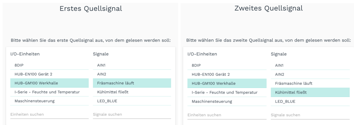
Abb. 71: I/O-Verwaltung > Synthetische Signale > Synthetisches Signal bearbeiten (Beispiel) Beispiel: Wenn der Signalwert des Digitaleingangs 1 (DIO1) ausgibt, dass die „Fräsmaschine läuft“ und der Signalwert des Digitaleingangs 2 (DIO2) ausgibt, dass das „Kühlmittel fließt“, dann wird das hier hinzugefügte synthetische Signal erzeugt, welches einen (wie auch immer definierten) Maschinenzustand ausgibt.
