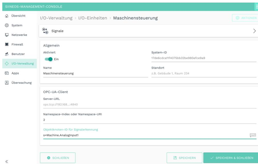
**Abb. 49: Geräteeinstellungen des OPC UA Clients (beispielhafte Darstellung)**
