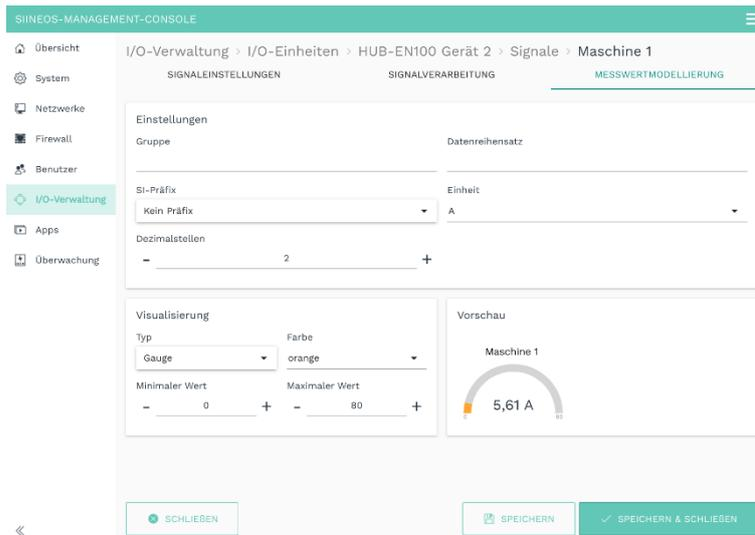
**Abb. 76: Messwertmodellierung des Signals „Maschine 1“**
