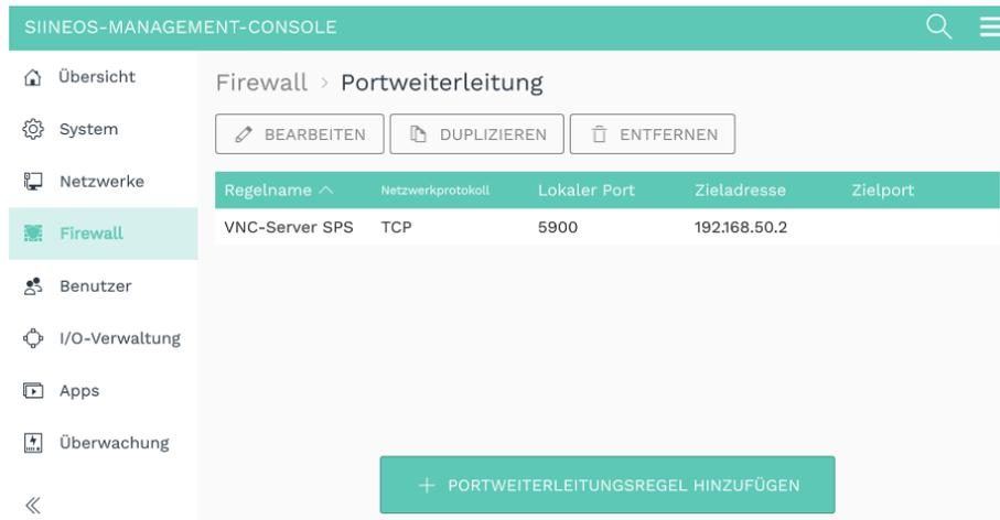
**Abb. 21: Firewall > Portweiterleitung (beispielhafte Darstellung)**
