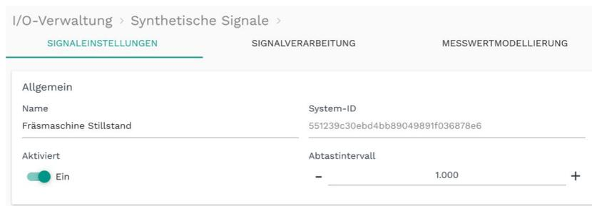
**Abb. 64:** Tabkarte „Signaleinstellungen“ des ausgewählten synthetischen Signals
