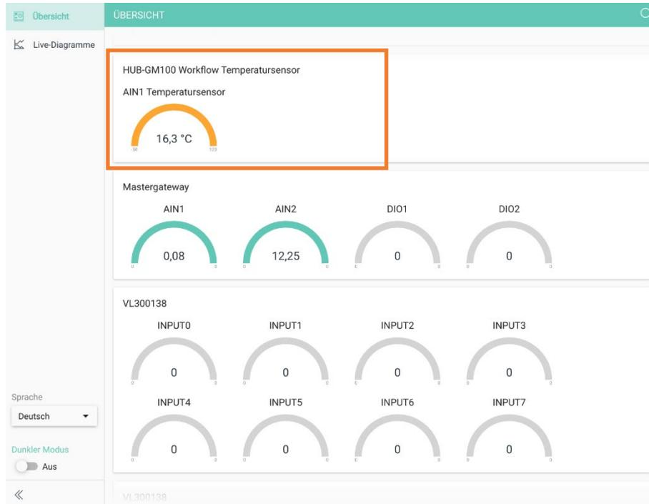
**Abb. 73: FlexPlorer mit der Anzeige des Temperatursensors, der an die Schnittstelle AIN1 angeschlossen ist**
