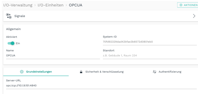
Geräteinstellungen des OPC-UA-Clients (Beispiel)
