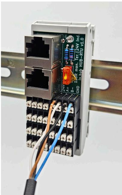
Alle Adern eines RTU-Gerätes sind angeschlossen (Beispiel)
