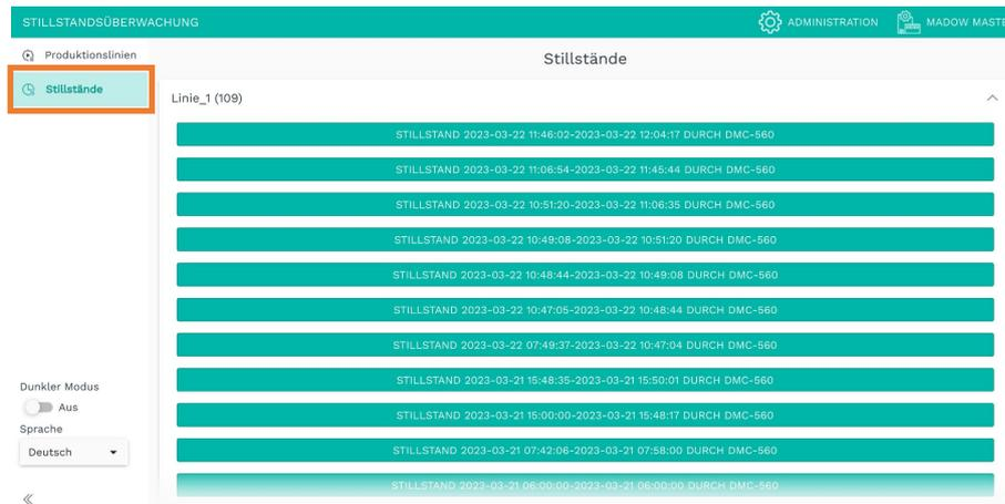
**Abb. 5: Übersicht aller unquittierten Stillstände einer ausgewählten Produktionslinie (beispielhafte Darstellung)**
