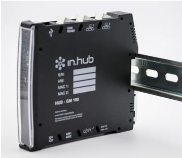
Montieren Sie das Gateway fachgerecht an die Tragschiene in Ihrem Schaltschrank.
