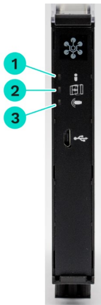
Abb. 2: LED-Statusanzeige an der Frontseite des HUB-GM100
