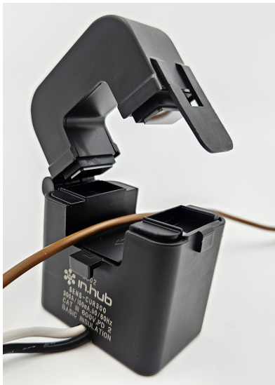
Geöffneter SENS-CUR-Stromsensor mit stromführendem Kabel, daneben das Schema zum Anschluss des Stromsensors
