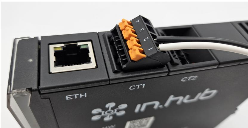
Anschluss eines SENS-CUR-Stromsensors am HUB-EN200
